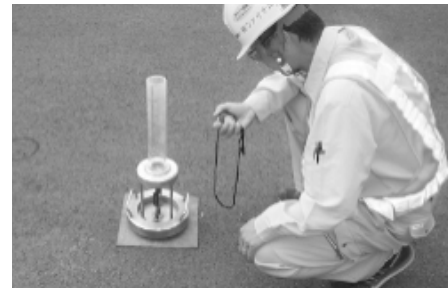
現場透水試験
