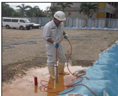
鉛直探査状況
